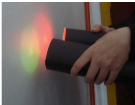
Figura 2 – Experimento “Composição da luz em cores”. Nesta figura podemos perceber que sobrepondo a luz verde e a luz vermelha obtemos a luz amarela, que é uma das cores secundárias da luz.
