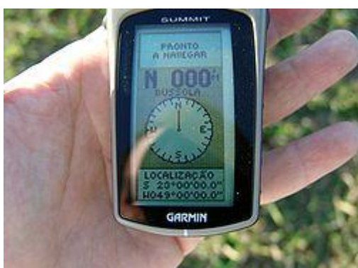
Imagem 5: GPS com Bússola e altímetro integrado GPS utilizado em um carro Fonte: Wikipédia ( http://pt.wikipedia.org/wiki/Sistema_de_posicionamento_global )
